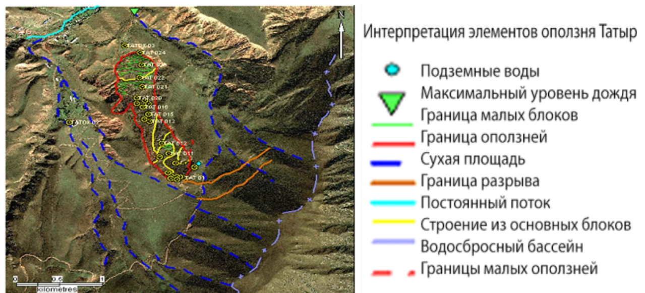
Рис.1.2.9. Схема геологического и тектонического строения района оползня Татыр
