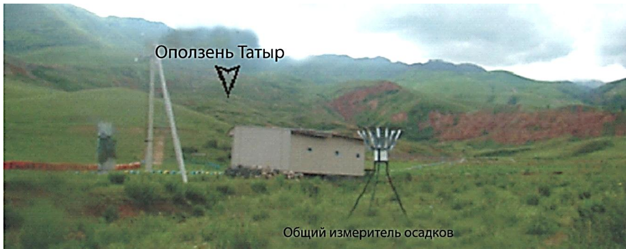
Рис. 1.2.13. Суммарный осадкомер, расположенный вблизи оползня Татыр
