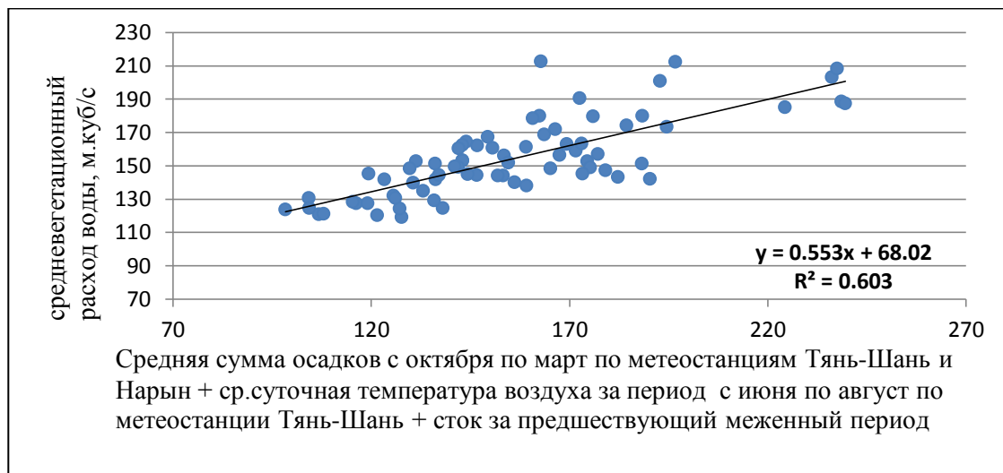
Рис. 2.3.2.14. Зависимость средних вегетационных расходов воды ГПНН от средней суммы осадков с октября по март по метеостанциям Тянь-Шань и Нарын + средняя температура воздуха за период с июня по август по МС Тянь-Шань + сток за период с октября по март ГПНН
