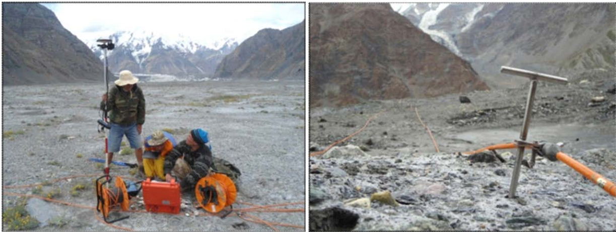
Рис. 2.2.2.2 Аппаратура вертикального электрического зондирования GeoTom-MK1E100 и дифференциальная DGPS ProMark-3 (ровер-станция). На правом фото – электрод и многожильные кабели крупным планом.
