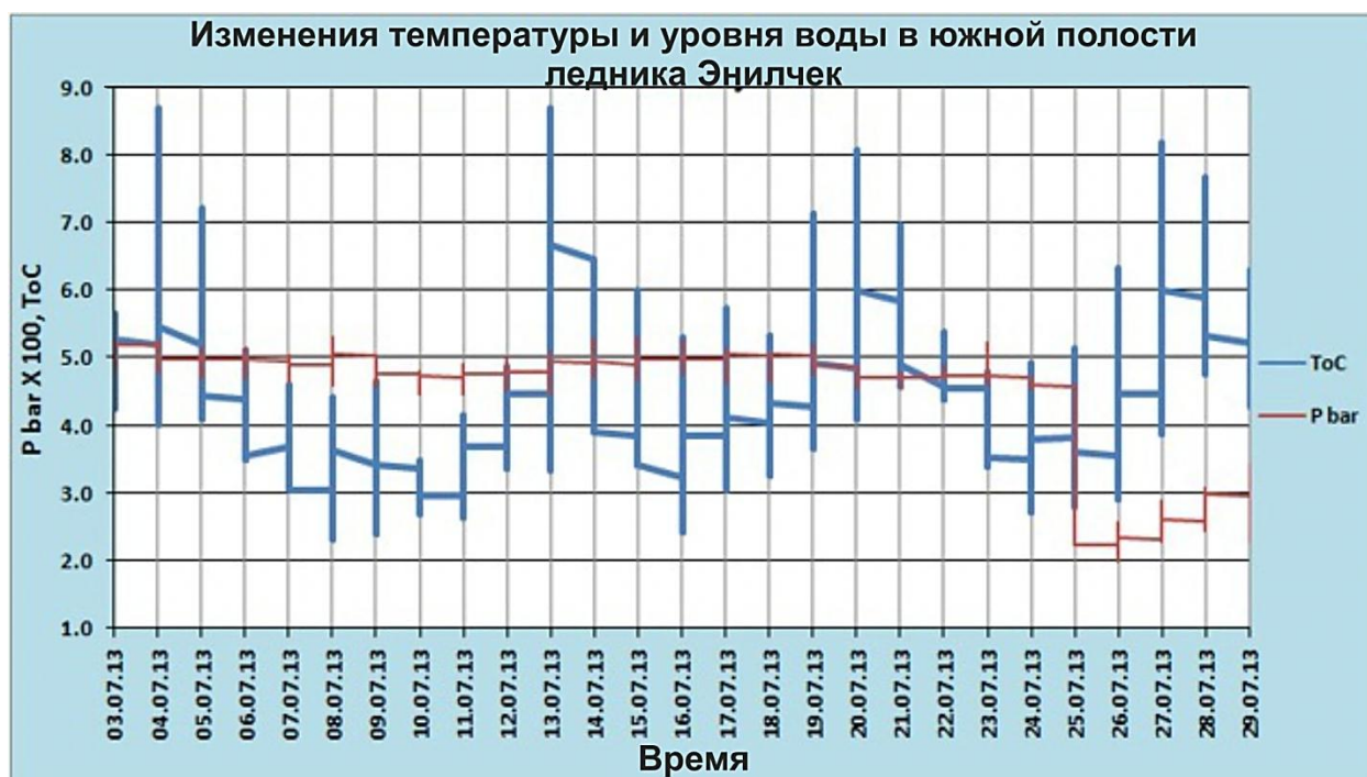
Рис. 2.2.1.6 Изменения температуры и давления воды по сенсору «ОТТ Orpheus»
