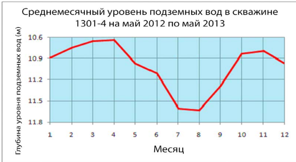
Рис. 2.3.6.3. Колебания уровня подземных вод по скважине 1301-4
