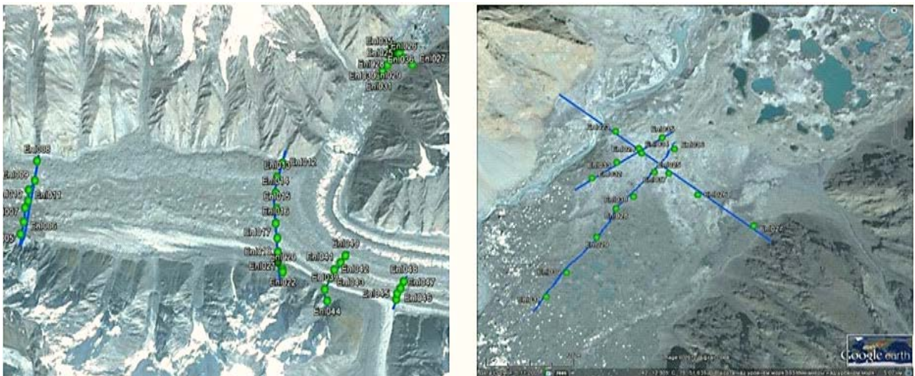
Рис. 2.2.3.6.. Расположение пунктов измерений сейсмических шумов: слева - по четырем профилям на леднике Эныльчек (всего 48 точек) и справа – по трем профилям на перемычке (16 точек).
