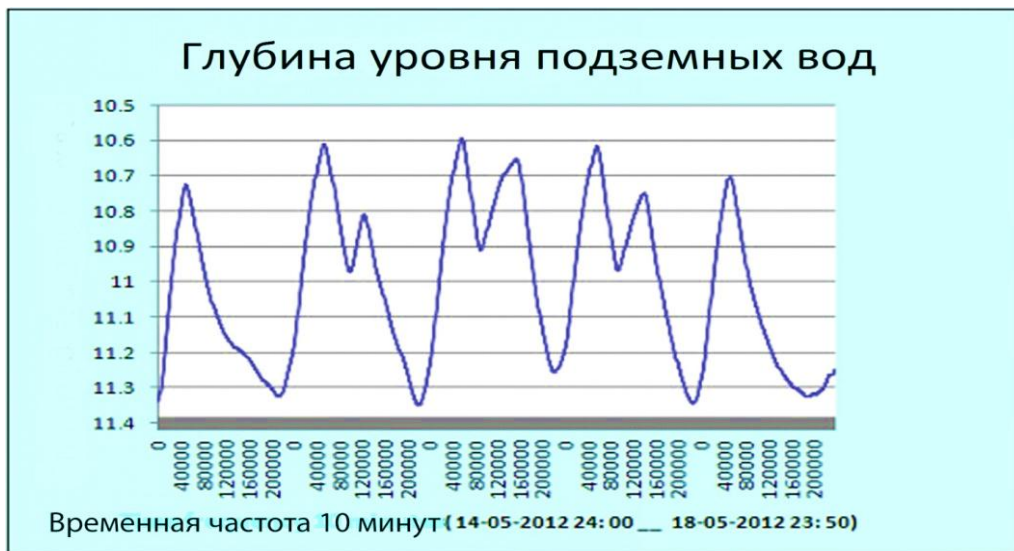
Рис. 2.3.6.4. Глубина залегания подземных вод
