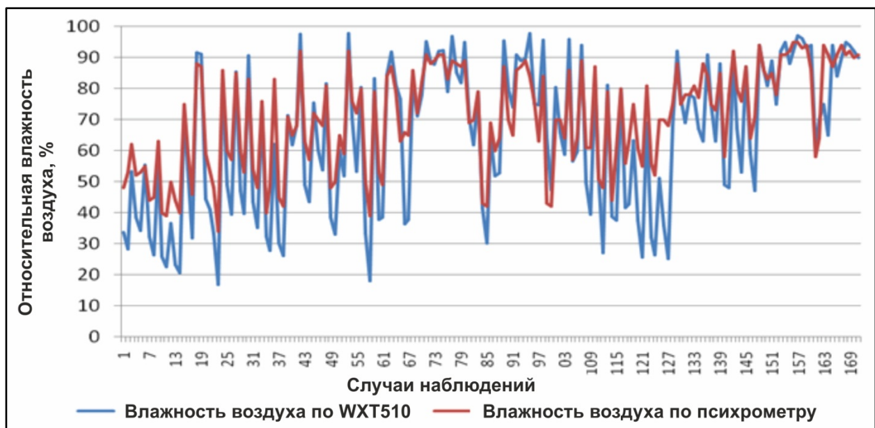
Рис. 2.1.1.2. Графики изменения относительной влажности воздуха по данным датчика WXT510 (синий цвет линии) и психрометру (красный цвет линии) метеорологической станции ГМО КРСУ.
