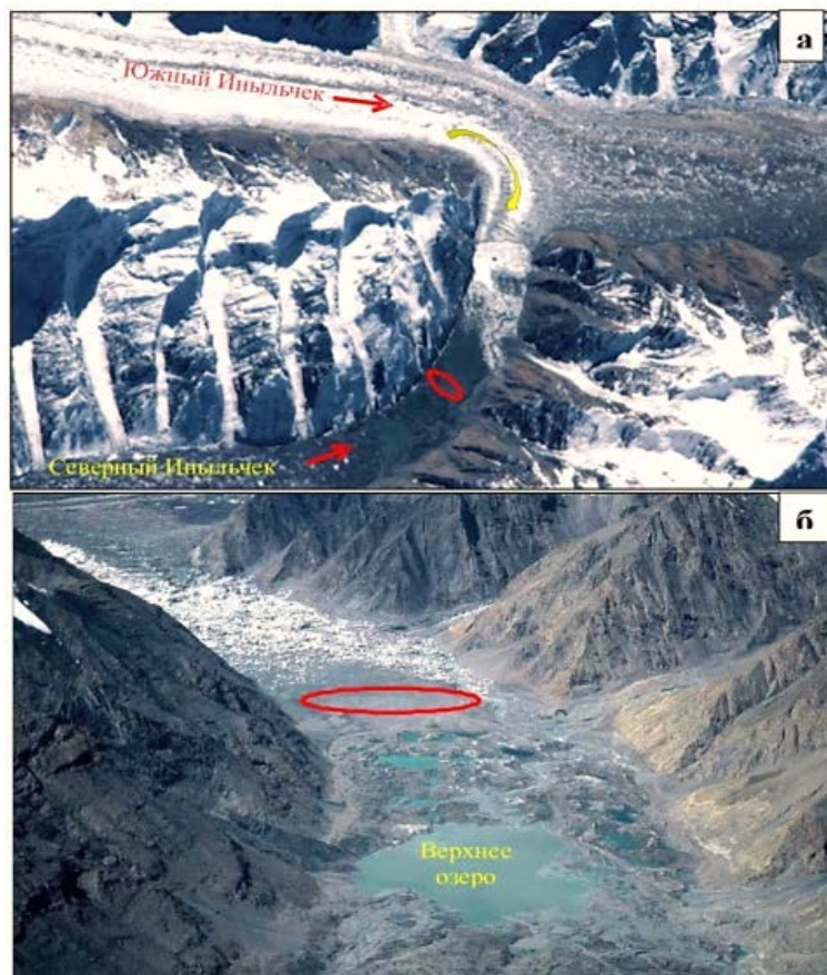
Рис. 2.2.2.1 Общий вид озера Мерцбахера: а) космоснимок района исследований – жёлтая стрелка указывает затекающий на север поток ледника Южный Энилчек; б) вид со стороны ледника Северный Энилчек; овалом выделен исследуемый участок перемычки между Верхним и основным озёрами.
