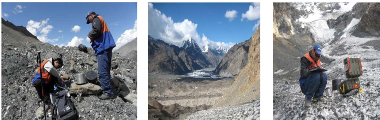
Рис. 2.2.3.1. Измерение сейсмических шумов на леднике Южный Энилчек в районе озера Мерцбахера: слева – поверхность морены ледника Южный Энилчек; в центре - обзорный снимок ледника Южный Энилчек и справа - левобережный приток ледника Южный Энилчек вблизи малого висячего ледника, расположенного к юго-востоку от обсерватории ЦАИИЗ.
