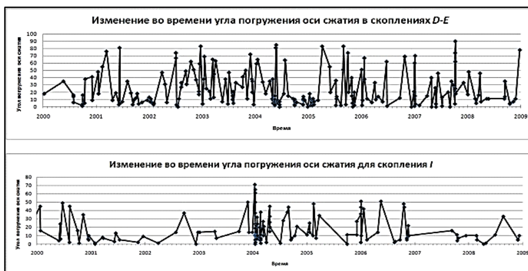
Рис. 1.3.4. Изменение во времени величины угла между горизонтом и осью сжатия в скоплениях D-E (верхний график) и I (нижний график).
