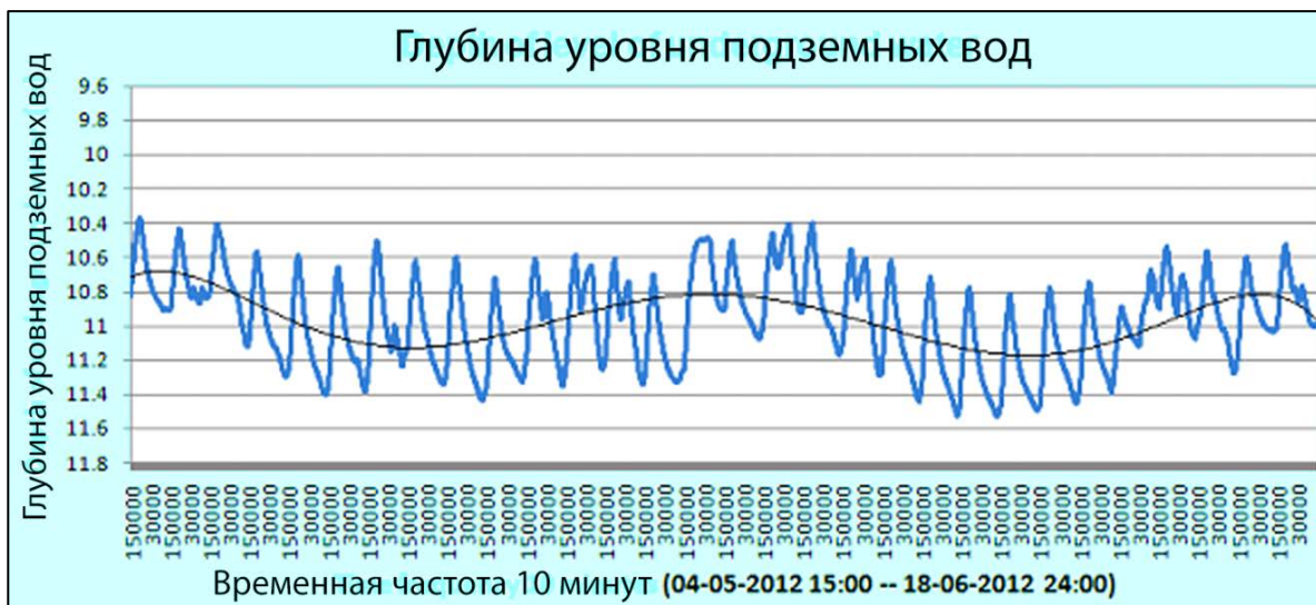
Рис. 2.3.6.5. Глубина залегания подземных вод
