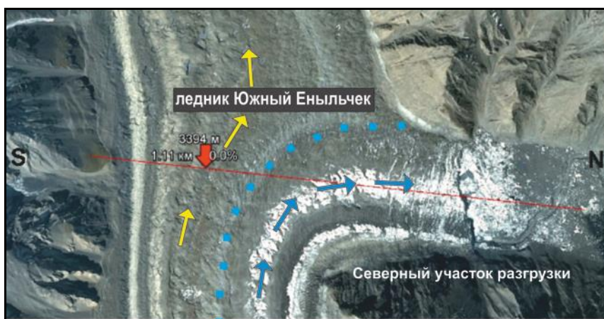
Рис. 15 Северный участок промежуточной разгрузки ледника Южный Еныльчек в озеро Мерцбахера. Стрелки синие- направление движения северного потока льда, желтые - южного потока. Пунктирная линия - граница между потоками.
