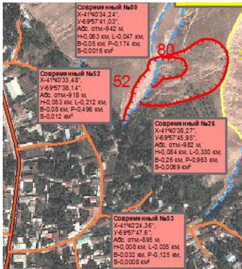
Рис. 5. Крупно масштабная вырезка из космосхемы с параметрической характеристикой оползневых участков
