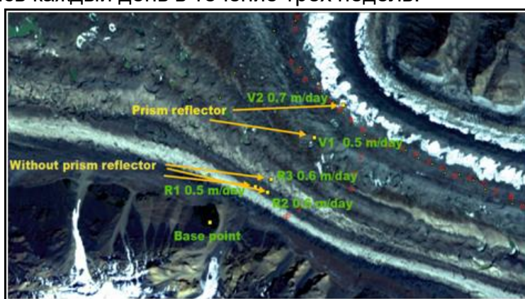
Рис. 28. Расположение отражателей на леднике Южный Еныльчек и средняя скорость движения льда в каждой точке.
