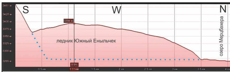
Рис.16 Профиль по DEM SRTM3 вдоль участка разгрузки (см.рис.15). Синяя пунктирная линия- предполагаемая боковая и нижняя граница ледника.
