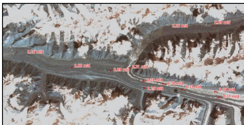
Рис. 28. Скорости движения поверхностного льда на ледниках Южный и Северный Еныльчек
